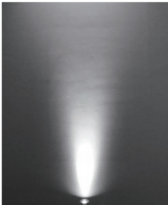
Photo réalisée avec un échantillon avec un angle de faisceau de 16.5°
